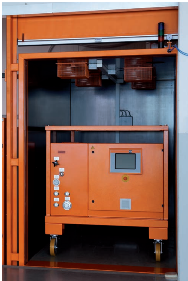
Пример Атмосферные испытательные камеры с автоматической дверцей
