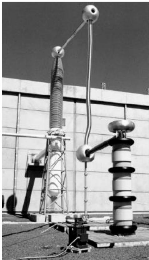
Рис. 10.1: Цепь резонансного испытания, подключенная к КРУЭ через проходной изолятор элегаз/воздух
